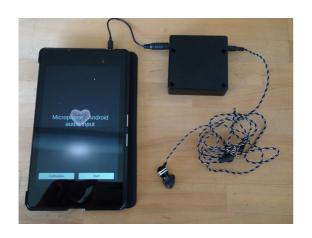
Vital信号はアダプタから4極イヤホンジャックのマイク端子を通じて送られています。スマートフォン、PCの内部回路に手を加えることができれば、すべて中に収容することが可能ですが、アダプタを用いることで、過去の機種を含めAndroid, iPhoneなど異なったプラットフォーム上で表示ソフトを入れ替えるだけで使うことができます。
